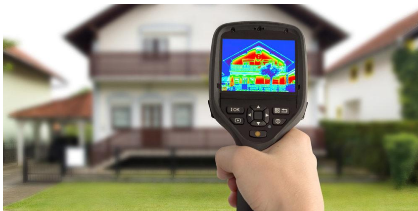
Slika 66 Ručna termalna kamera (Kontrol biro, 2024)
