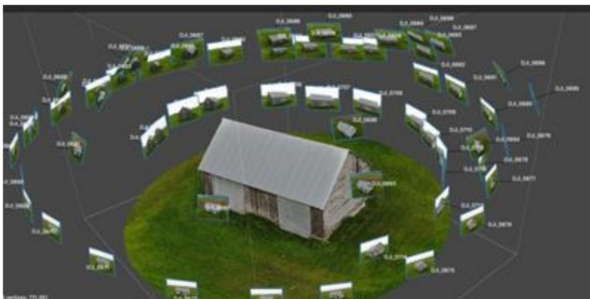
Slika 50 Putanja bespilotne letjelice s preklapanjima
