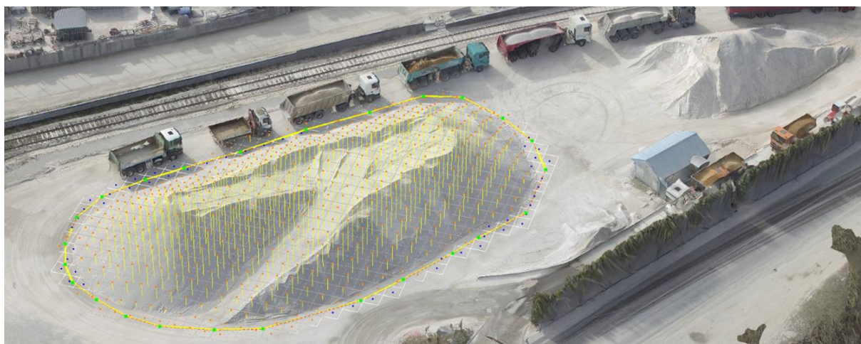
Slika 55 Primjena fotogrametrijskog modela kod proračuna volumena deponije
