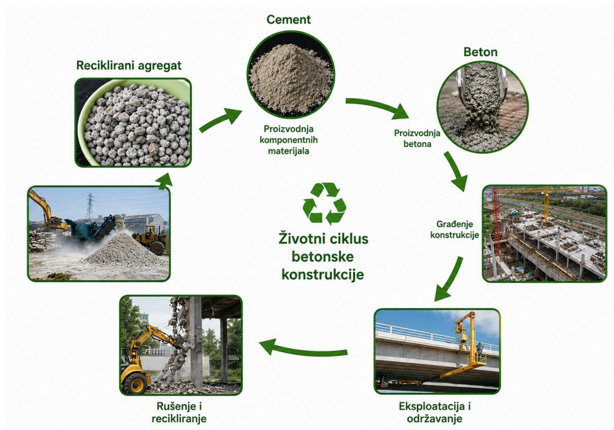
Slika 44 Životni ciklus betonske konstrukcije
