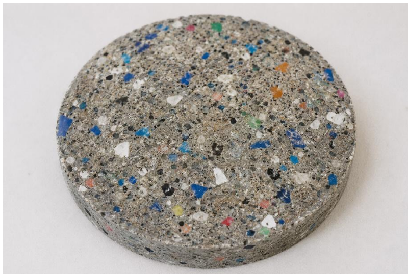
Slika 277 Beton od reciklirane plastike
