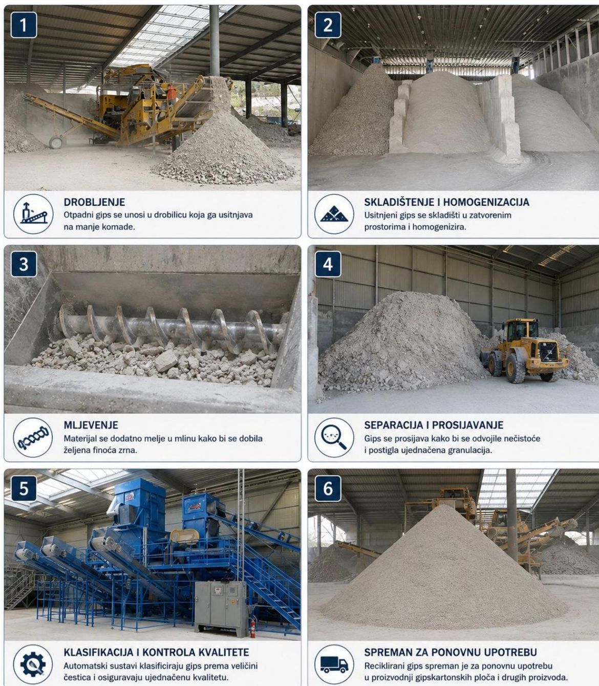
Slika 21 Strojevi za proces recikliranja gipsa
