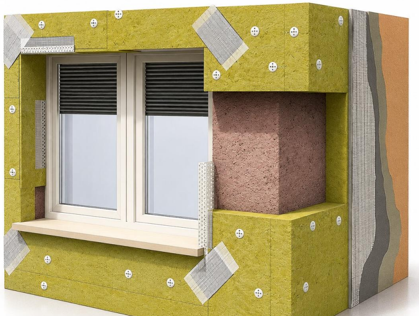
Slika 7 Primjer toplinske izolacije vanjskog zida zgrade
