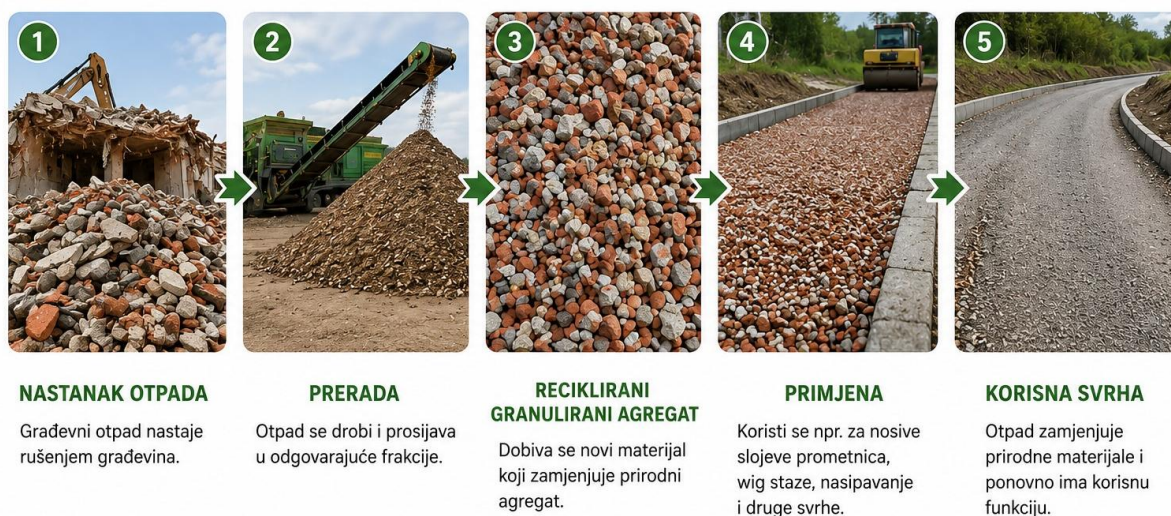
Slika 6 Oporaba građevnog otpada preradom u reciklirani granulirani agregat za ponovnu primjenu u graditeljstvu
