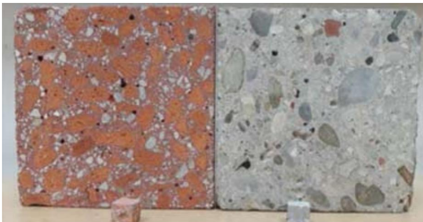
Slika 266 Beton s recikliranim agregatom: lijevo – reciklirani agregat od drobljene opeke (Ivana Banjad Pečur, Bojan Milovanović, Dubravka Bjegović, Nina Štirmer, Marina Bagarić, Ivana Carević, 2020)
