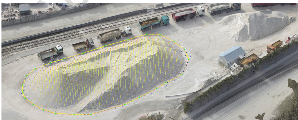
Slika 116 Primjena fotogrametrijskog modela kod proračuna volumena deponije
