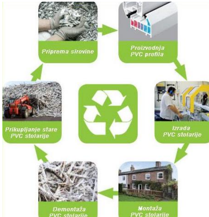
Slika 19 Postupak recikliranja PVC stolarije (MR PVC sistem, 2024)
