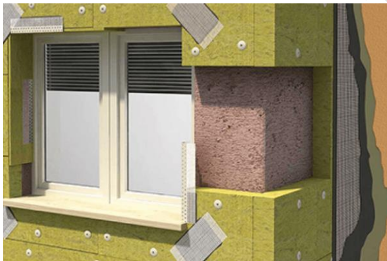
Slika 7 Primjer toplinske izolacije vanjskog zida zgrade (Bellcom Hrvatska, 2024)
