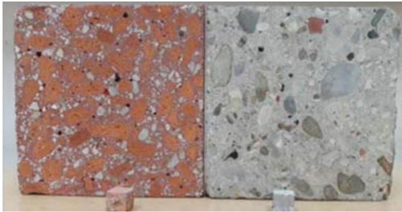
Slika 28 Beton s recikliranim agregatom: lijevo – reciklirani agregat od drobljene opeke (Ivana Banjad Pečur, Bojan Milovanović, Dubravka Bjegović, Nina Štirmer, Marina Bagarić, Ivana Carević, 2020)
