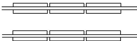
c) specijalne AB ploče ( kod konstrukcije gornjeg ustroja bez zastora, gdje nije moguće osigurati gabarit klasičnom konstrukcijom kolosijeka)
